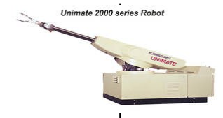
Unimate voit le jour en 1961 Ce bras articulé de 1.5 tonnes est destiné à l'industrie automobile en plein essor.
