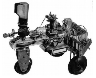
La tortue cybernétique de W;Grey Walter (1950) était équipée de capteurs tactiles et lumineux lui permettant d'explorer son environnement.
